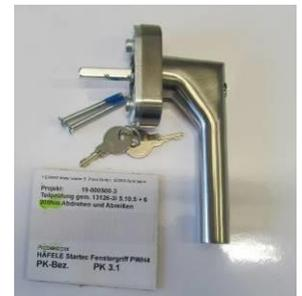
**Besonderheiten** Der Probekörper wurde abweichend der Anforderungen nach EN 1627 : 2011; Tabelle B1 bis 200 Nm gegen gewaltsames Abdrehen und Abreißen nach EN 13126-3 2011 positiv geprüft.
