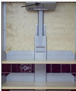
Kontrollieren Sie, dass der Hubriemen unbeschädigt ist.
