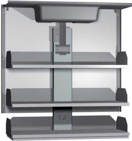
Der Schrankeinsatz Verti besteht aus einer Grundplatte, die an der Wand montiert wird, einem Hebemechanismus und einem Einsatz mit drei Böden. Die vertikale Hub- und Senkbewegung entsteht durch einen elektromotorgetriebenen Hubriemen, der zwischen der Grundplatte und dem Einsatz montiert ist.
